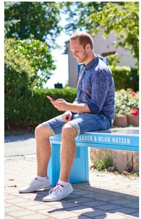
Sitzfläche im Sommer nicht zu sehr aufheizt, wird sie über eine Lüftung gekühlt; im Winter hingegen ist sie im Sonnenlicht dank der dunklen Oberfläche der Solarzellen wärmer als ihre Umgebung.
